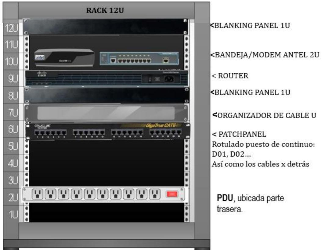
\*Para sujetar cables en todo su trayecto usar Cinta de Velcro, **no precintos o Sunchos plásticos**
