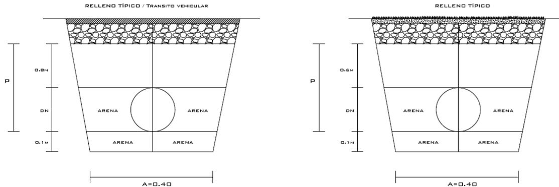
Las dimensiones mínimas de las excavaciones en zanjas, definidas por el ancho uniforme  $A$  y la profundidad  $P$  quedan establecidas por las siguientes fórmulas:
