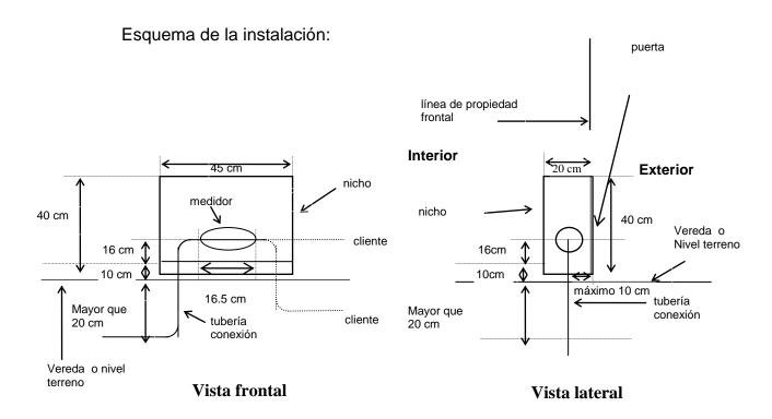
Se especifican las dimensiones mínimas externas del nicho con el propósito de facilitar la estandarización de las conexiones existentes. Como puede apreciarse en las figuras precedentes (vista frontal, vista lateral) se establecen las dimensiones máximas a la que debe estar colocado el medidor, tanto en altura como en profundidad, a efectos de facilitar la lectura del medidor.
