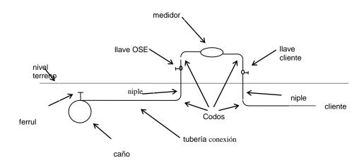
La llave de cierre perteneciente a O.S.E. va instalada al lado del medidor dentro del nicho, el tipo de llave a utilizar deber ser llave esférica, con cierre y apertura en cuarto de vuelta.
