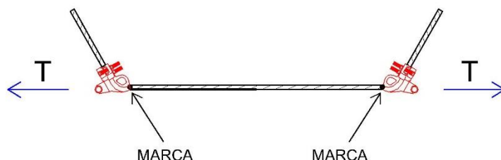
Figura 8: Esquema de ensayo de deslizamiento para grapas de amarre
