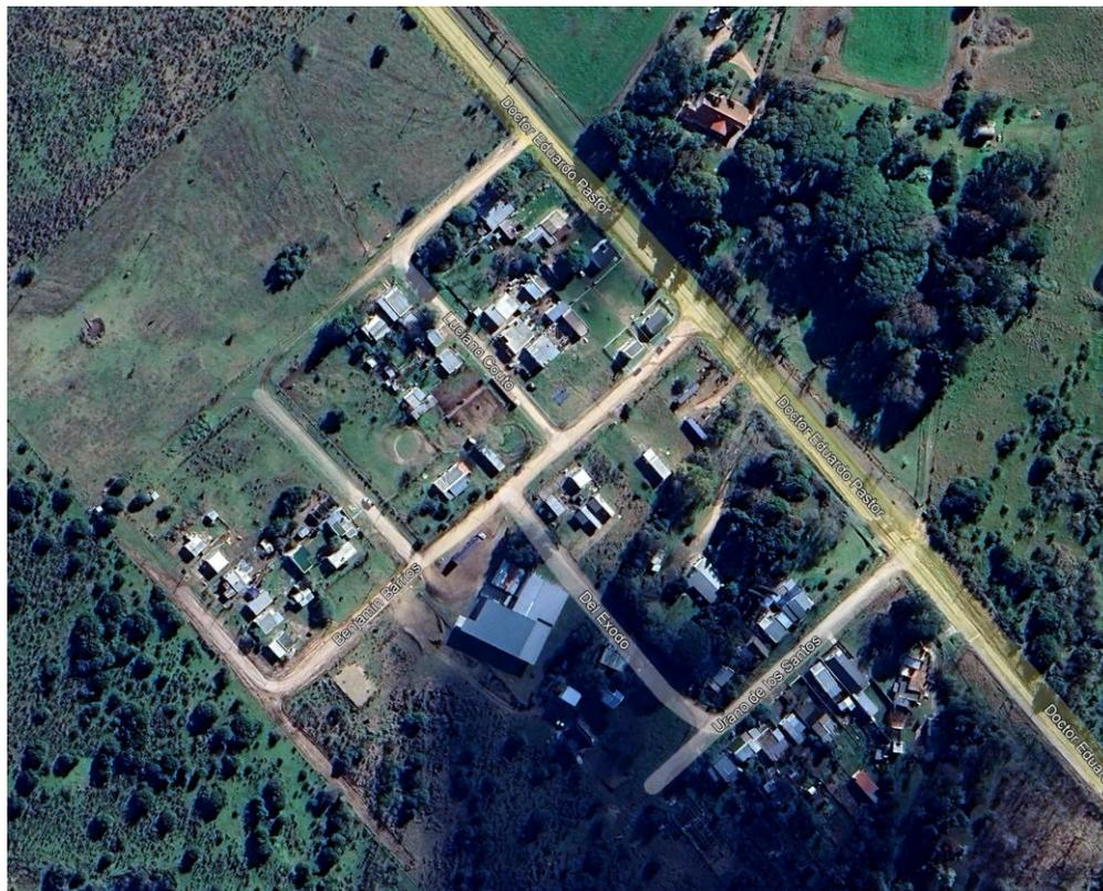
Los trabajos a realizar en esta zona consisten en la readecuación del ancho de cada calle de esa zona, llevándolo a 6 m. En algunos casos puntuales se deberá construir la calle (porque es casi inexistente) mediante las tareas de conformación de subrasante y cunetas, además de recargo con material granular en un espesor que oscila entre los 15 y 30 cm. A continuación, se especifica el espesor de recargo a aportar en cada calle, su largo y su ancho pretendido:
