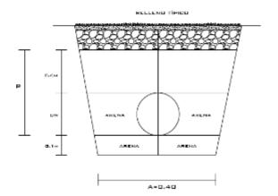
Las dimensiones mínimas de las excavaciones en zanjas, definidas por el ancho uniforme A y la profundidad P quedan establecidas por las siguientes fórmulas:
