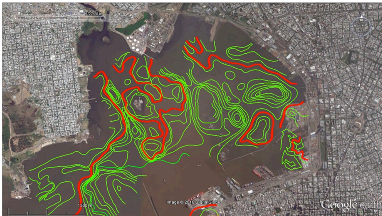
Figura 5 - Plano topográfico del techo firme (basamento acústico) a partir de los estudios realizados por EIH - Grimaux (1987) y Geo proyectos (2002)
