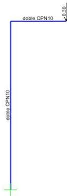
Sección hueca tipo cajón formada por 2UPN 10,  $W_x=82,4 \text{ cm}^3$ ,  $A=27 \text{ cm}^2$
