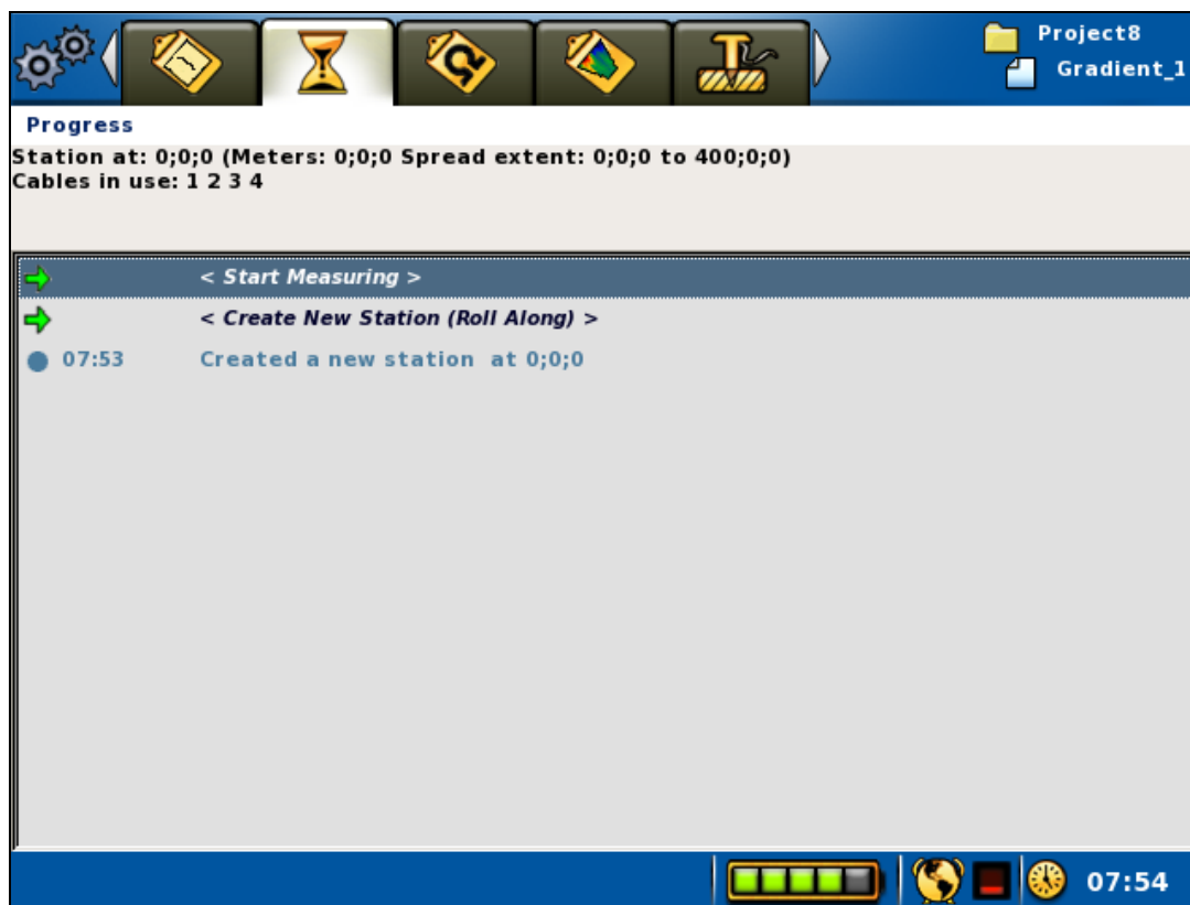
Figura 48. Comando de inicio de mediciones en la Vista de progreso de mediciones
