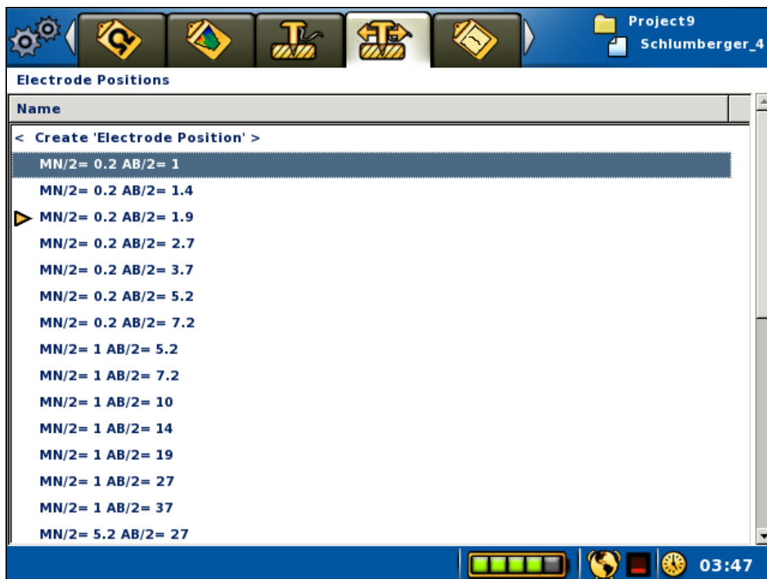
Figura 62. La Vista de Posición de Electrodo en el modo SEV. La segunda línea se encuentra resaltada, y la posición del electrodo activo se encuentra en la cuarta línea.
