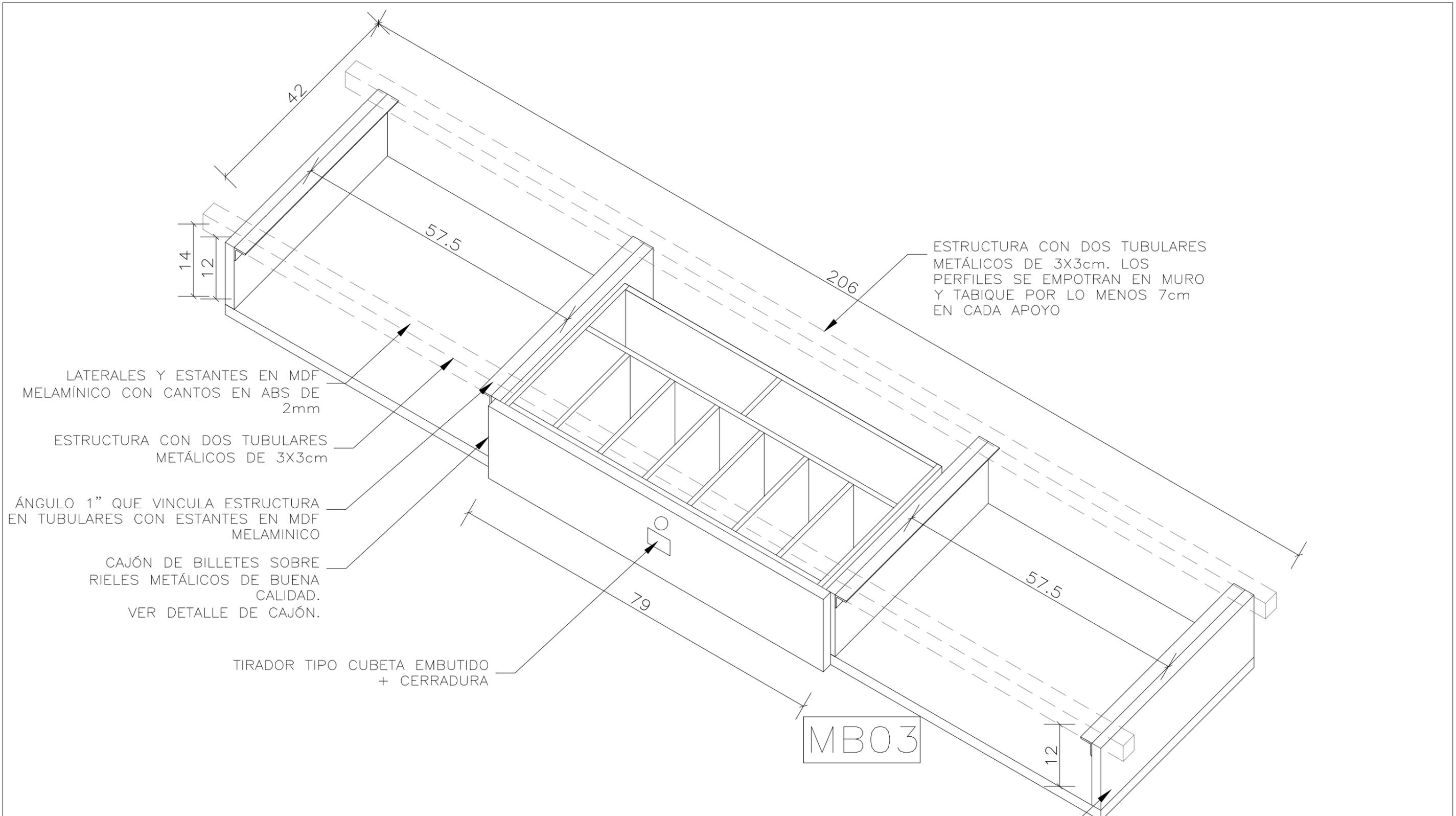
ESTRUCTURA CON DOS TUBULARES METÁLICOS DE 3X3cm. LOS PERFILES SE EMPOTRAN EN MURO Y TABIQUE POR LO MENOS 7cm EN CADA APOYO
