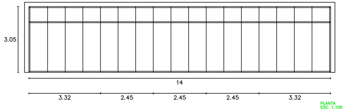
Se propone sustituir la estructura por perfilaría de aluminio, piel de vidrio y la cubierta con termopaneles (DVH), compuesto por un vidrio templado por el interior y vidrio laminado y tonalizado hacia el exterior.
