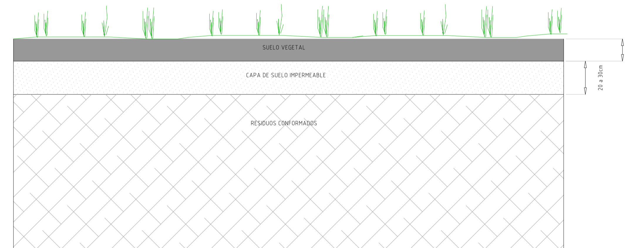
DETALLE 06 COBERTURA FINAL ESCALA 1/20
