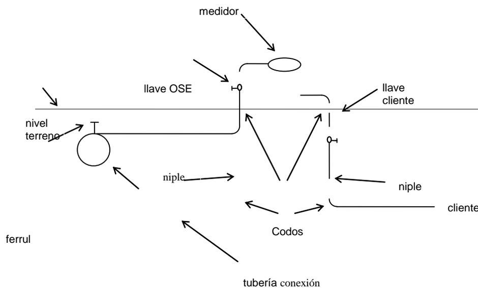
La llave de cierre perteneciente a O.S.E. va instalada al lado del medidor dentro del nicho, el tipo de llave a utilizar deber ser llave esférica, con cierre y apertura en cuarto de vuelta.
