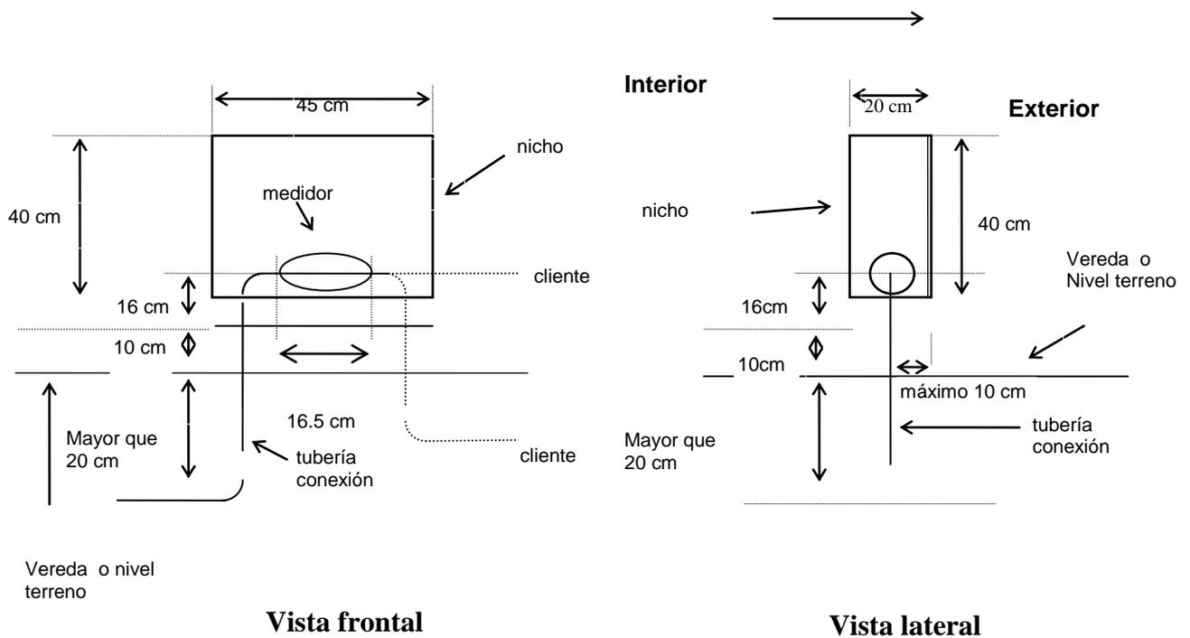
Se especifican las dimensiones mínimas externas del nicho con el propósito de facilitar la estandarización de las conexiones existentes.
