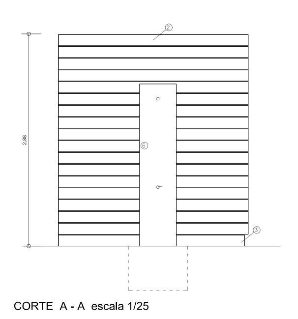
Platea hormigón armado armadura mallalur 15x15x 3,5 mm refuerzo 2 g/ 8 en los bordes
