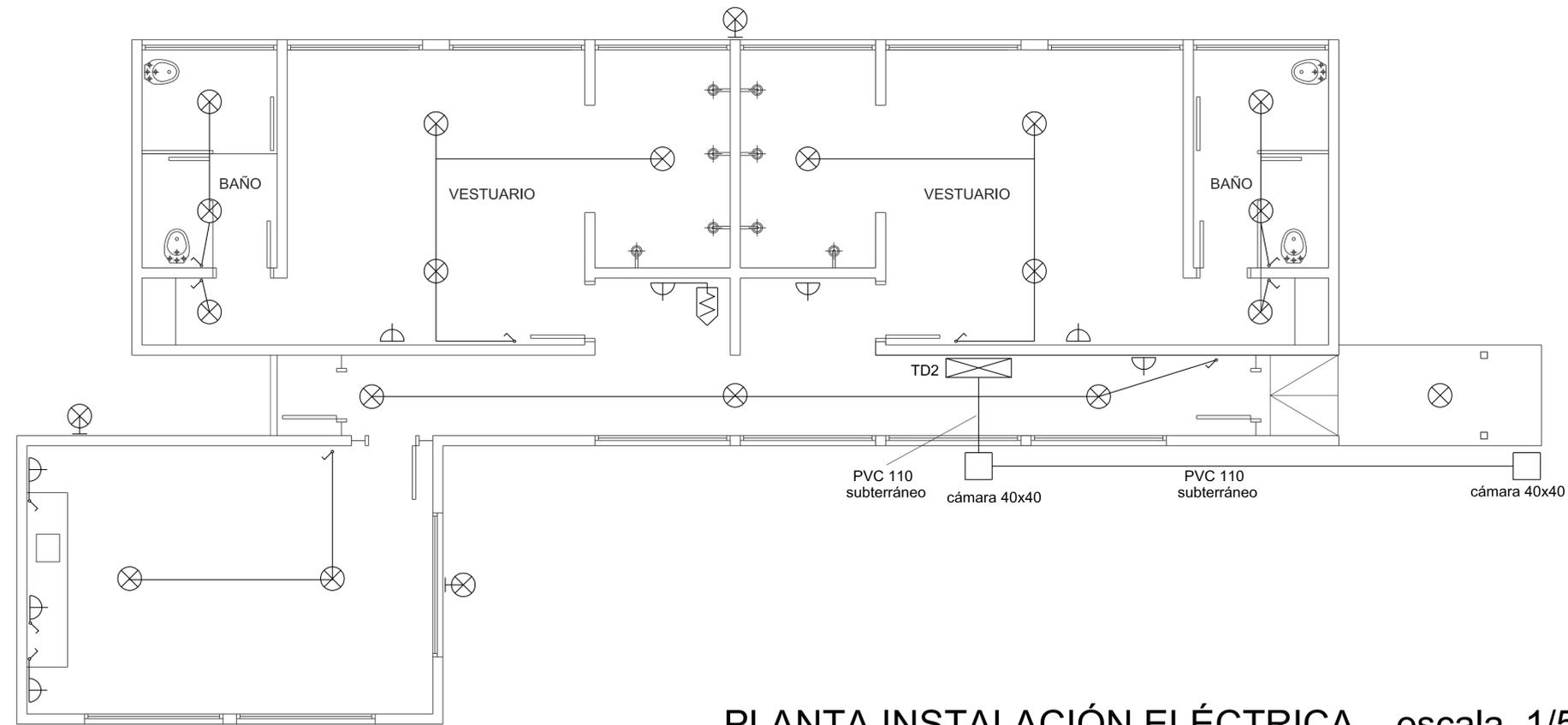
PLANTA INSTALACIÓN ELÉCTRICA escala 1/50
