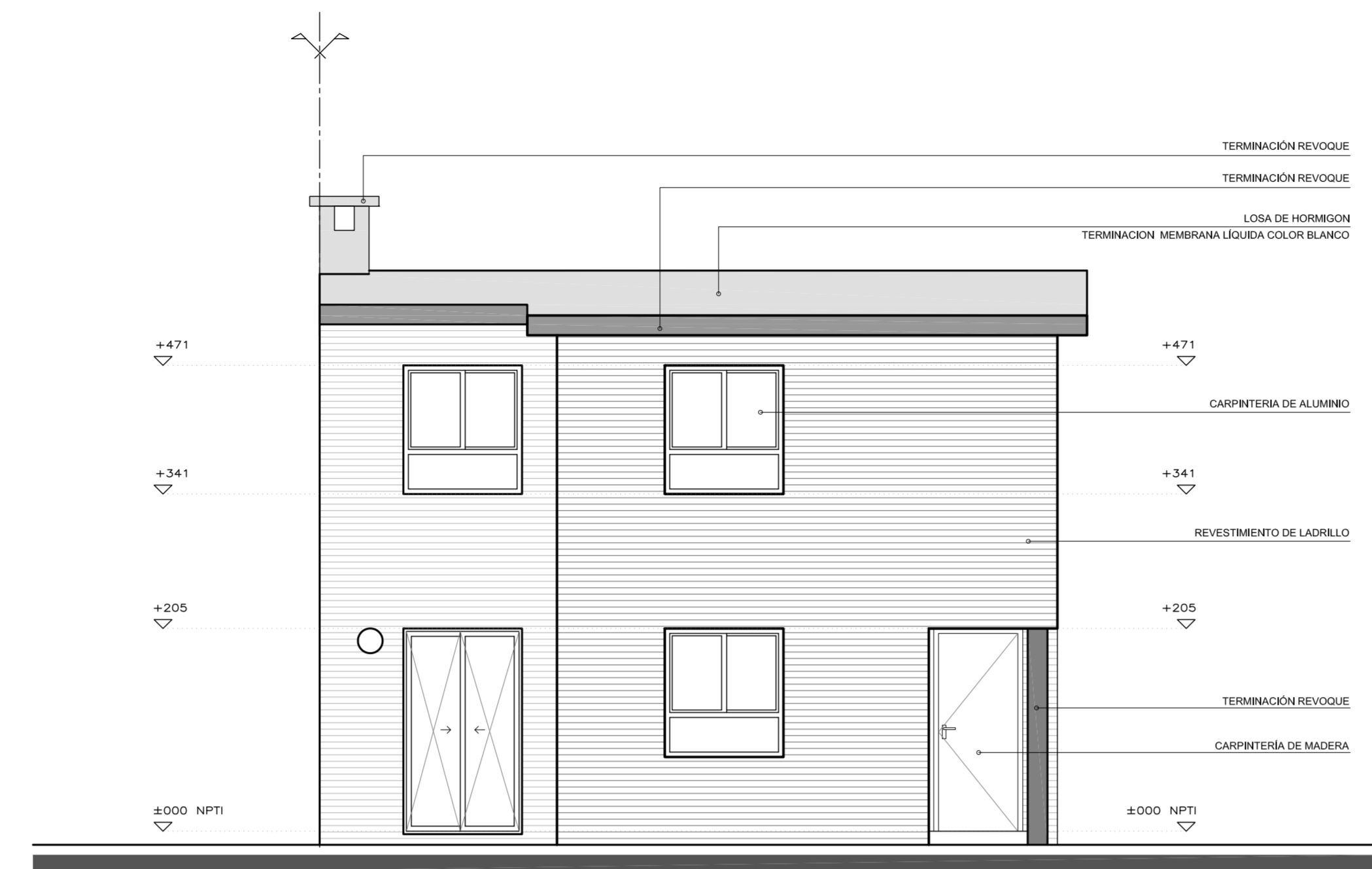
FACHADA LATERAL ESCALA 1/50
