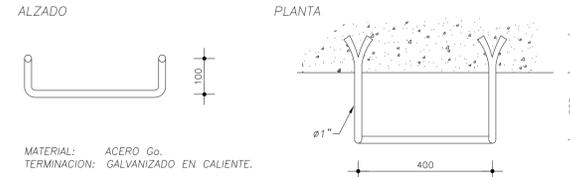
**DETALLE ARMADURA LOSA SUPERIOR**
