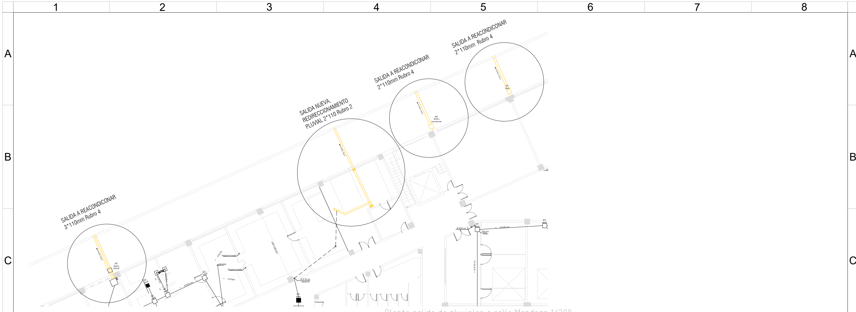
Planta salida de pluviales a calle Mendoza 1/200
